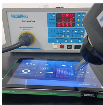
3.1 静电放电测试图 Electrostatic discharge test
