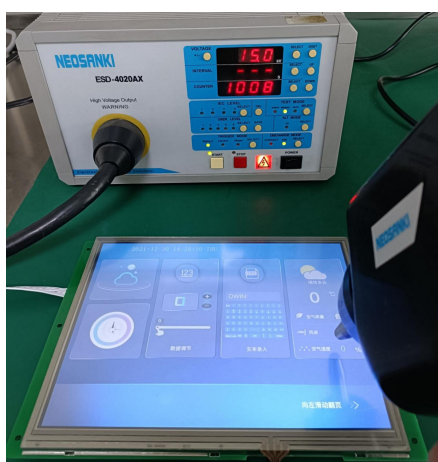
3.1 静电放电测试图 Electrostatic discharge test
