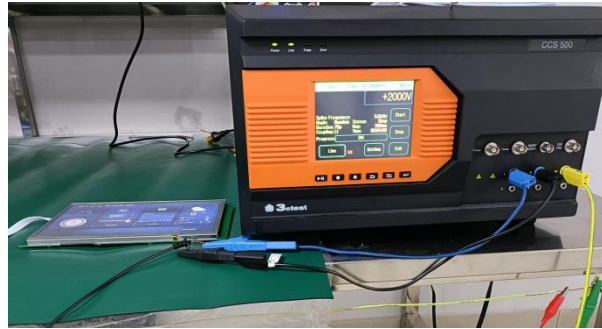
3.2 EFT test
