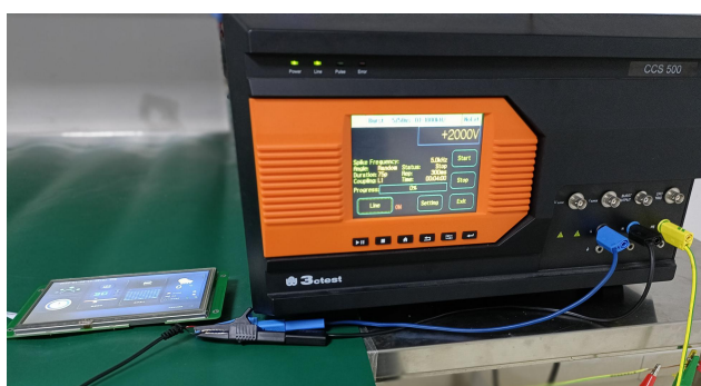
3.2 群脉冲测试图 EFT test
